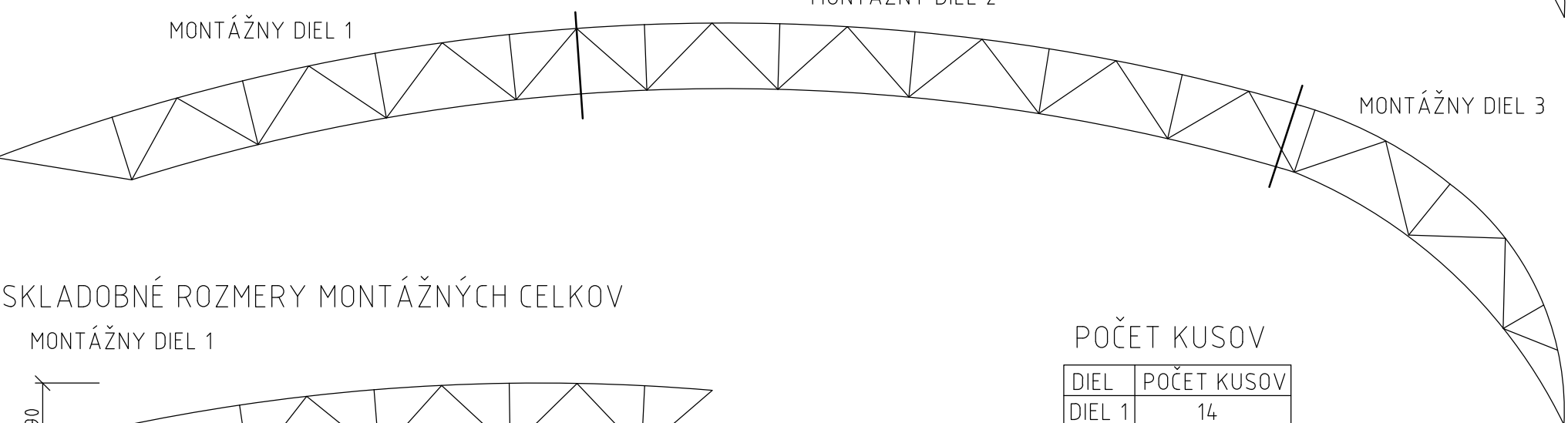
ROZDELENIE VAZNÍKA NA MONTÁŽNE CELKY
